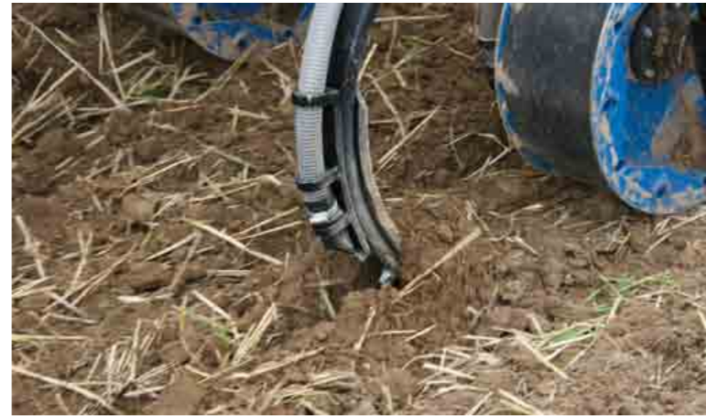
Localisation précise de la semence par les dents-semeuses
